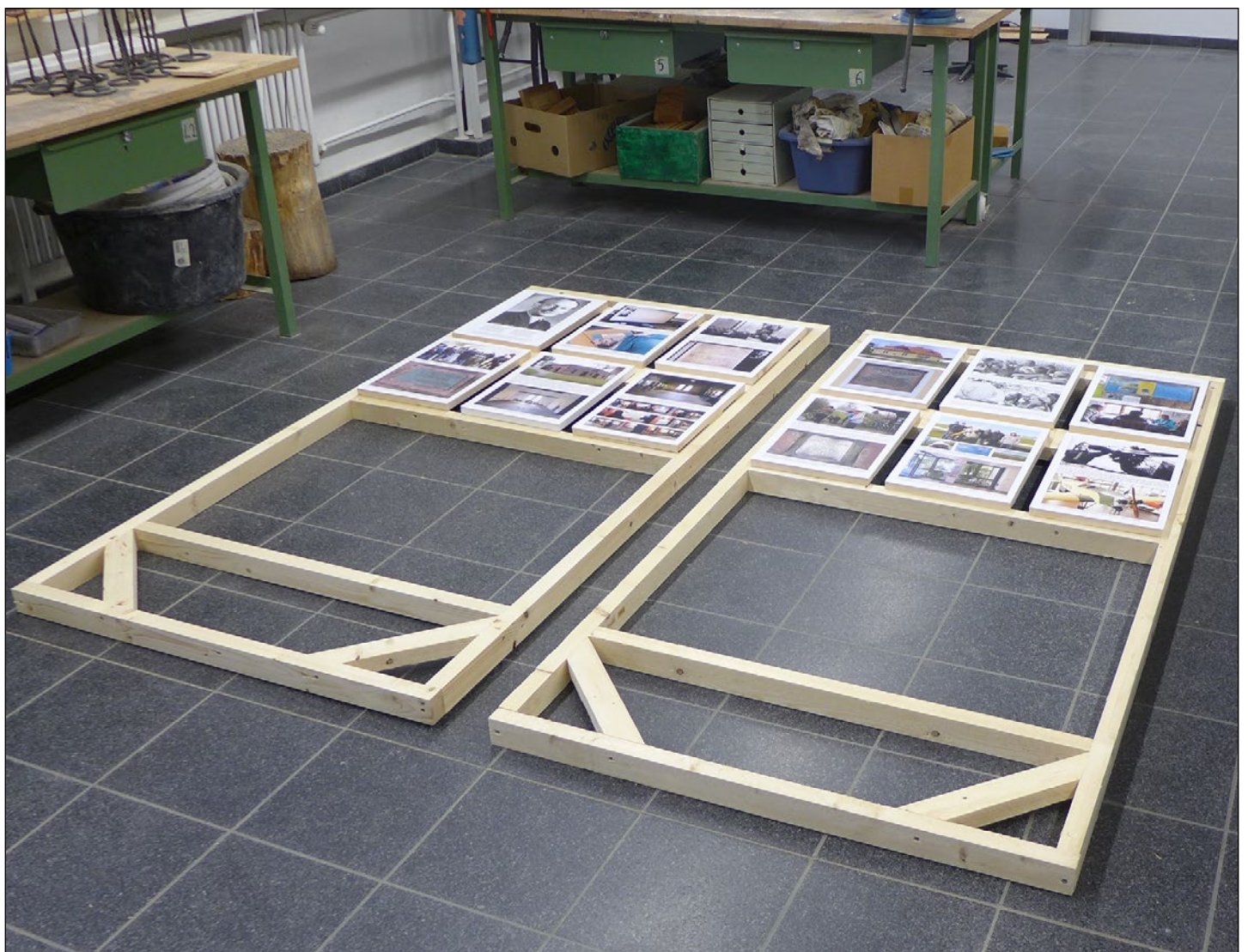
Konstruktion der linken und rechten Stellwand.
